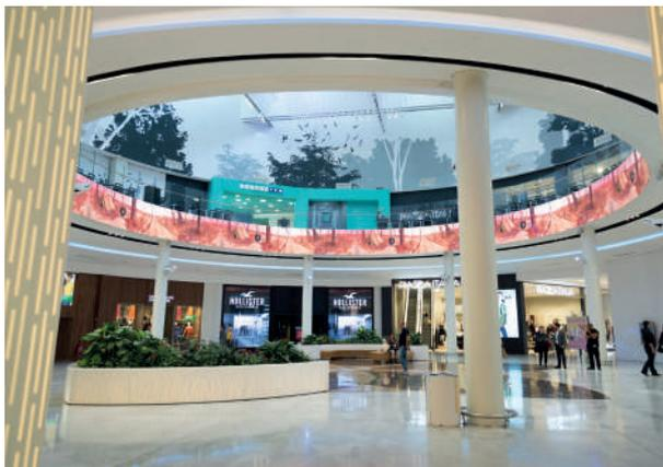
Nel Centro Commerciale I Gigli di Campi Bisenzio, Firenze, **3P Technologies** ha realizzato un Digital Ring, ledwall circolare, con una circonferenza di circa 70 metri per 160 cm di altezza, sul quale vengono visualizzati contenuti video dinamici grazie al sistema di digital signage appositamente ingegnerizzato.
